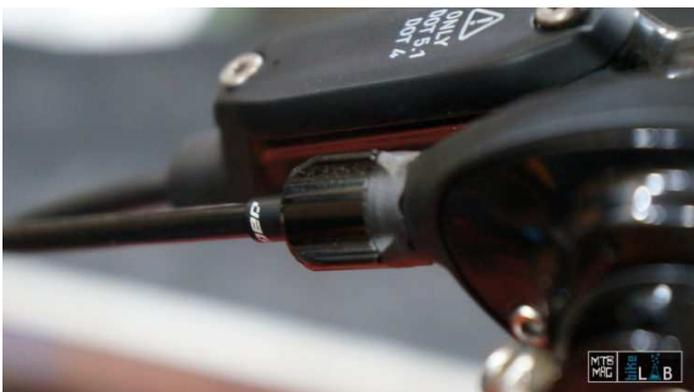
La **tensione del cavo** è la regolazione principale del nostro deragliatore e si regola tramite un apposito registro sul manettino.
