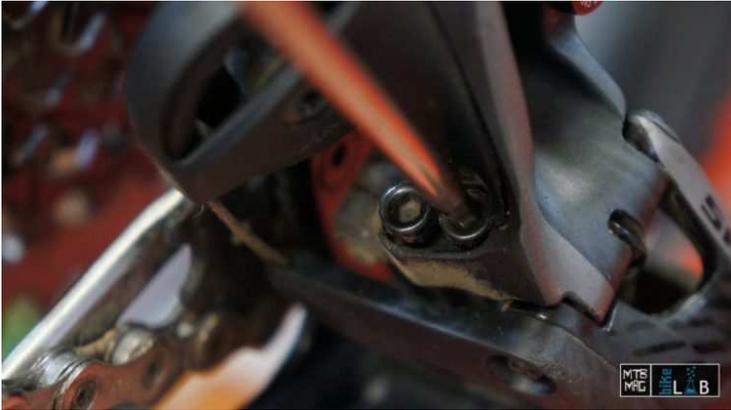
Se il cambio è stato regolato bene, i **finecorsa inferiore e superiore** non andrebbero mai toccati. Può capitare tuttavia che, con le vibrazioni, le viti si possano allentare ed il fine corsa perda la sua regolazione.
